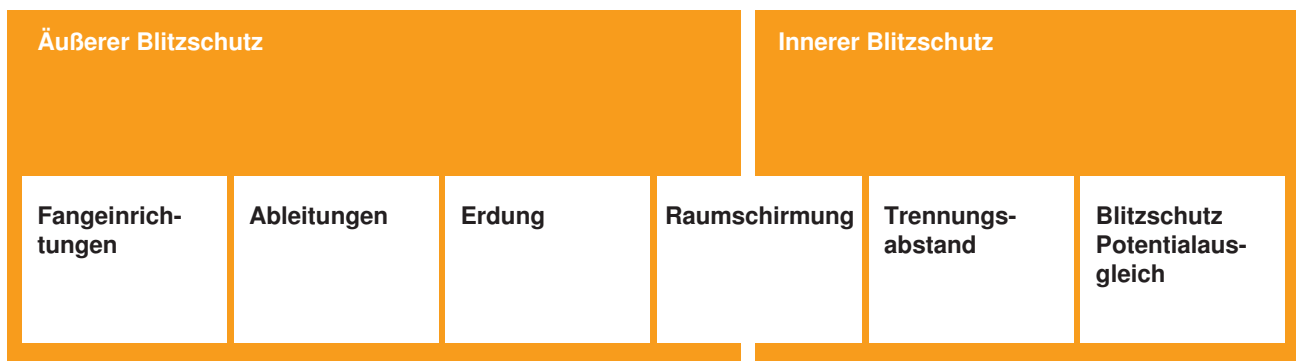
Systeme des äußeren und inneren Blitzschutzes
