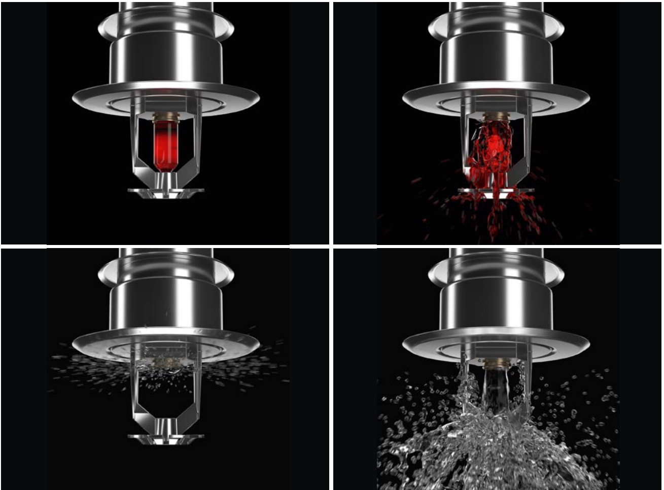
Auslösen eines Sprinklerkopfes bei Überschreitung der Nenntemperatur von 68 °C am Glasfässchen
