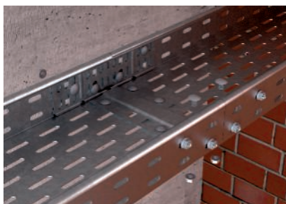
Längsverbinder und Stoßstellenleiste mit Flachrundschrauben befestigen.
