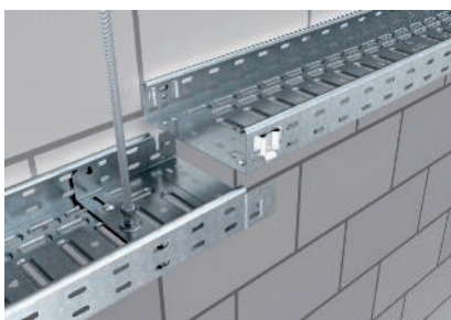
Erstellen der Längsverbindung durch Ineinanderstecken der Kabelrinnen.
