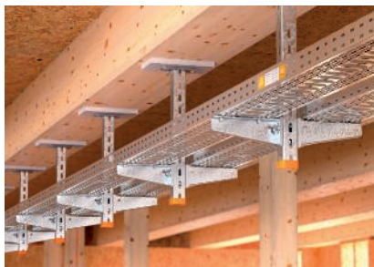
Hängestielmontage unter dem Holzbalken mit hinterlegter Brandschutzplatte.
