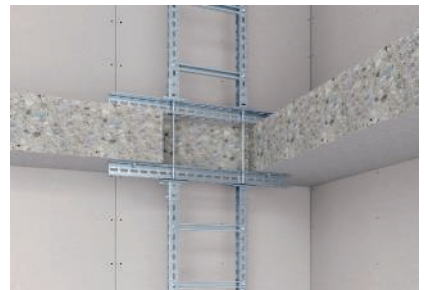
Montage der Steigeleiter im direkten Verlauf unter einer Deckenöffnung mit Querprofilen und Kopfplatten.
