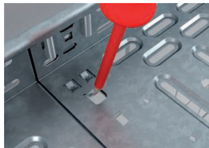
Schraubenlose Stoßstellenverbindung, nur Umbiegen der Bodenlaschen erforderlich.
