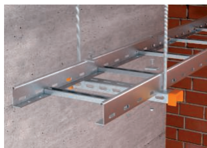
Montage auf Querprofil mit Klemmstück, Flachrundschrauben und großen Unterlegscheiben.
