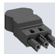
Buchsenteil 3-polig, Typ GST18i mit Schraubanschluss für Leitungen 1,5 - 4,0 mm<sup>2</sup> und für Leitungsdurchmesser von 10,5 - 14,5 mm (H05VV, NYM), unmontiert mit Zugentlastung, vor Ort konfektionierbar, 250 V, 16 A.
