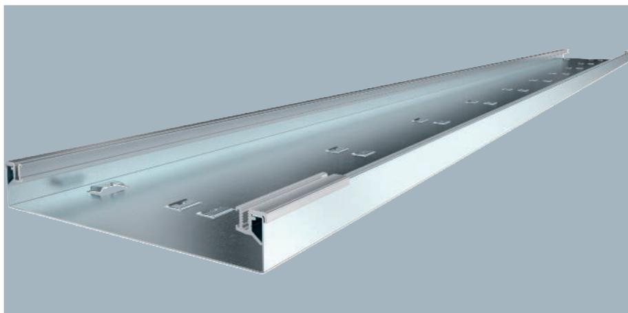
Abzweig-Aufflur-Installationskanal-Unterteil für Blind-/Montagedeckel mit beidseitiger Abschrägung, zur Montage frei auf dem Fußboden, mit aufsteckbaren Aluminium-Seitenprofilen zum Auflagern und Befestigen der Kanaldeckel. Kanalhöhe geeignet zum Aufbau von Teiltanks.
