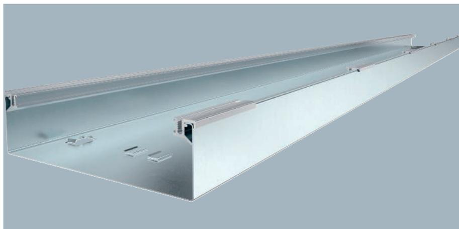
Aufflur-Installationskanal-Unterteil, 1-zügig, für Blind-/Montagedeckel mit einseitiger Abschrägung, mit aufsteckbaren Aluminium-Seitenprofilen zum Auflagern und Befestigen der Kanaldeckel, Bodenwanne mit Haltetaschen für max. 2 einsteckbare, selbstkontaktierende Trennsteg und Prägung für Schutzleiteranschlusswinkel. Kanalhöhe geeignet zum Einbau von Geräteeinbauten der Nenngröße 2.
