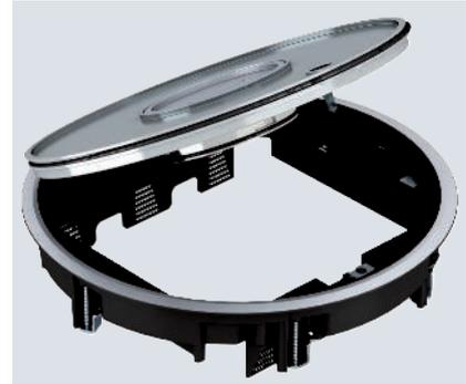
Geräteinsatz mit Tubus für nass gepflegte Böden für bis zu 12 Modul 45-Einzelgeräte in 3 Universalträger UT4, Einsatz in Kanalsystemen und Systemböden im Innenbereich. Oberfläche Aluminium glanzgedreht mit einer Bodenbelagsaussparung von 3 mm. Für eine Einbautiefe von 65 mm.
