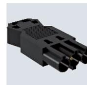
Steckerteil 3-polig, Typ GST18i mit Schraubanschluss, geringe Bauhöhe (kein Steckplatzverlust in Kombination mit Verteilerblöcken), für Querschnitt 0,75 - 2,5 mm<sup>2</sup>, ein- und feindrähtige Leiter ohne Aderendhülse anschließbar, für Leitungsdurchmesser von 6,5 - 10,5 mm (H05VV, NYM), unmontiert mit Zugentlastung, vor Ort konfektionierbar, 250 V, 16 A.
