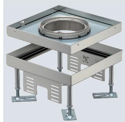
Nivellierbare quadratische Kassette Schwerlast für Tubus der Nenngröße 4 für den Einbau von Installationsgeräten in Kanalsystemen, Doppel- und Hohlböden in trocken oder nass gepflegten Fußböden im Innenbereich. Belastungsklasse 1 bis 10 kN.
