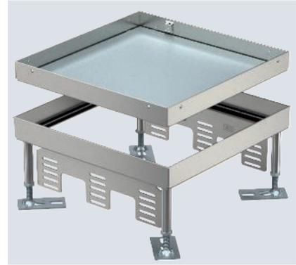
Nivellierbare quadratische Kassette "blind" für die Herstellung einer Revisionsöffnung der Nenngröße 9. Einbau in Kanalsystemen, Doppel- und Hohlböden in trocken oder nass gepflegten Fußböden im Innenbereich. Nur für glatte Bodenbeläge geeignet.
