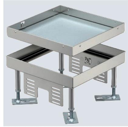
Nivellierbare quadratische Kasette "blind" für die Herstellung einer Revisionsöffnung der Nenngröße 4. Einbau in Kanalsystemen, Doppel- und Hohlböden in trocken oder nass gepflegten Fußböden im Innenbereich. Nur für glatte Bodenbeläge geeignet. Schutzklasse: IP X5.
