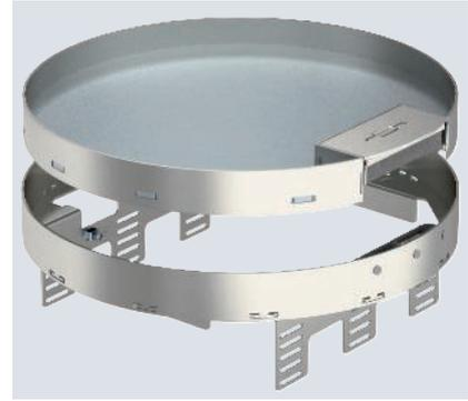
Nivellierbare und vom Fußboden entkoppelte Kassette der Nenngröße R9 mit Schnurauslass, für den Einbau von Installationsgeräten in trocken gepflegten Fußböden im Innenbereich, zur Montage in Unterflurdosen UZD350-3 in Verbindung mit einem Montagedeckel DUG350-3R9 oder in UGD350-3R9. Die Montage erfolgt mittels Nivellierwinkeln (separat bestellen) im Aluminium-Rahmenprofil der Unterflurdosen.
