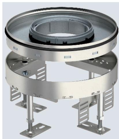
Runde Kassette Schwerlast für Tubus in Nenngröße R4 für den Einbau von Installationsgeräten in Kanalsystemen, Doppel- und Holzböden, in trocken oder nass gepflegten Fußböden im Innenbereich. Belastungsklasse 2 bis 20 kN.
