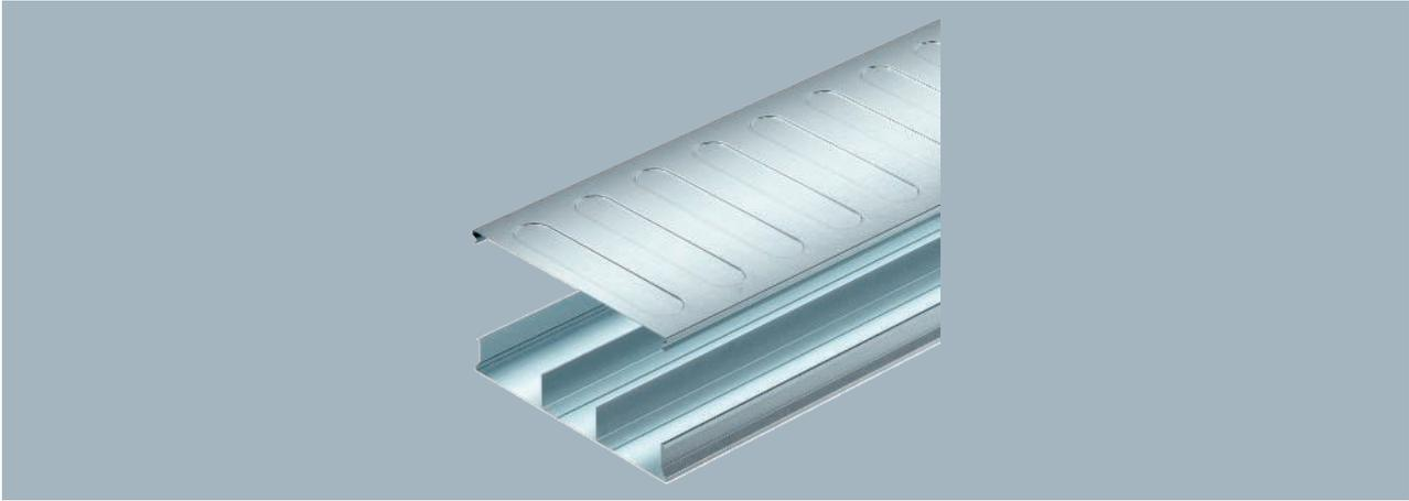
Unterflurkanal (2-teilig) zur Verlegung von Kabeln und Leitungen in estrichüberdeckten Unterflur-Systemen nach EN 50085-2-2. Abnehmbarer und durchgängig aufrastbarer Kanaldeckel. Mit Trennsteg im Kanalunterteil.
