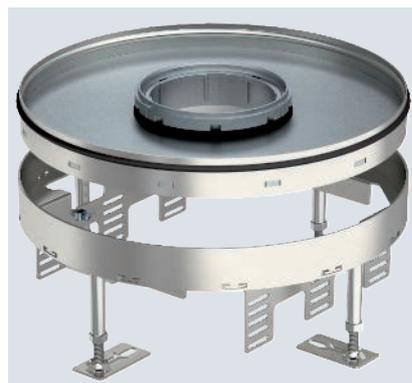
Runde Kassette Schwerlast für Tubus in Nenngröße R9 für den Einbau von Installationsgeräten in Kanalsystemen, Doppel- und Hohlböden, in trocken oder nass gepflegten Fußböden im Innenbereich. Belastungsklasse 2 bis 20 kN.
