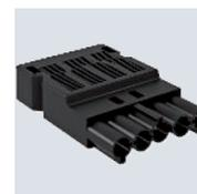
Steckerteil 5-polig, Typ GST18i mit Schraubanschluss für Leitungen 1,5 - 2,5 mm<sup>2</sup>, ein- und feindrähtig, mit Zugentlastung, ein Anschluss pro Pol, unmontiert, für Leitungen H05VV (Ø 9,5 - 13,5) NYM und (Ø 10,5 - 13,5 mm), verriegelbar, gemäß Zugentlastung nach VDE 0628 ist eine Verriegelung vorzusehen, 250 V, 16 A.
