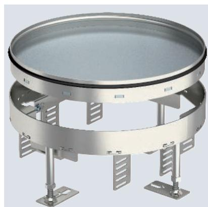
Runde Kassette Schwerlast "blind" in Nenngröße R7 für die Herstellung einer Revisionsöffnung in Kanalsystemen, Doppel- und Holzböden, in trocken oder nass gepflegten Fußböden im Innenbereich. Belastungsklasse 2 bis 20 kN. Nur für glatte Bodenbeläge geeignet.
