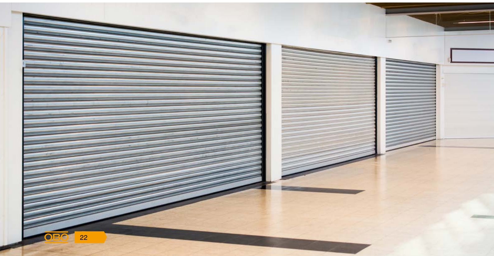
Rolltore mit Feuerwiderstandsklasse als Feuerschutzabschluss
