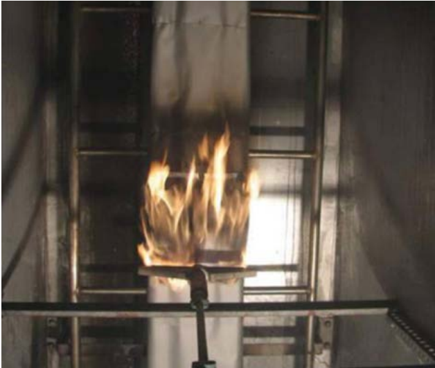
Prüfung der Kabelbandage
