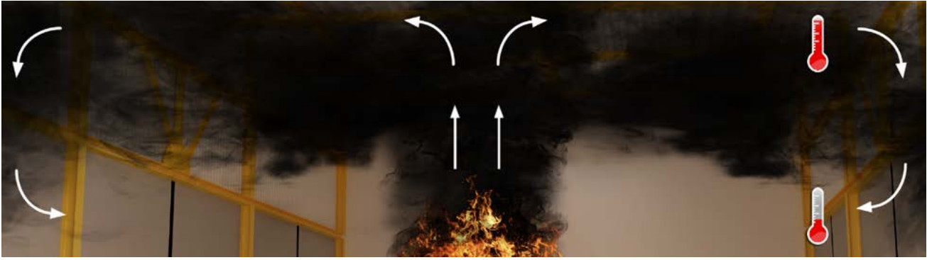
Wärmestau unter der Decke im Brandfall
