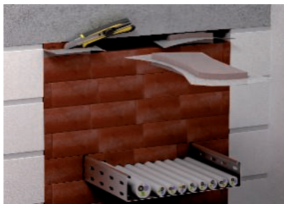
Vakuumblocke für einfachen Restspaltverschluss.
