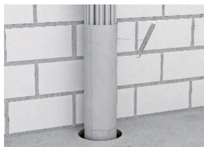
Fixieren der Bandage mittels Wickeldraht.
