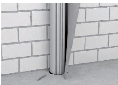
Installation der Brandschutzbandage.
