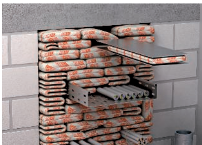
Bleche als Montagehilfe für die letzte Kissensenlage.
