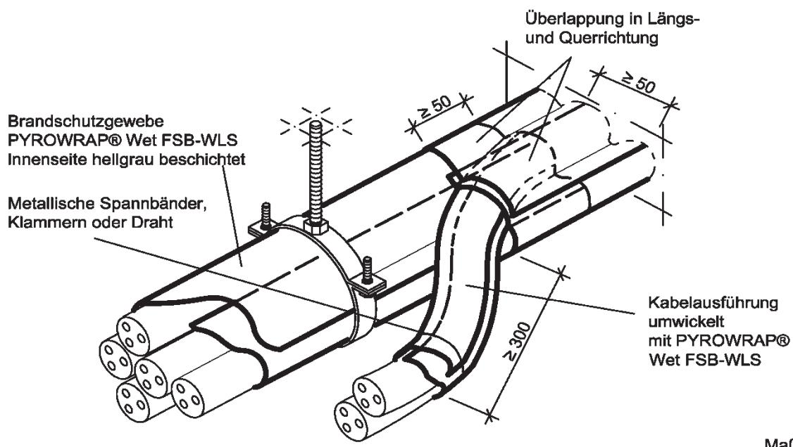
Umhüllungen von elektrischen Leitungen und Leitungsanlagen mit dem
