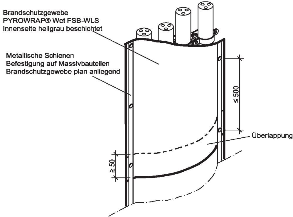
Ausführung von Kabeln- bzw. Ausgängen bei Anwendungen gemäß Abschnitt 1.2 (1) b)
