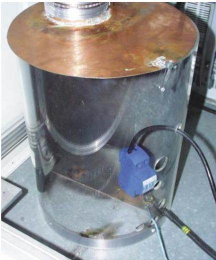
**Bild 5.** Prüfung eines geschlossenen Ableiters MC 125-B/NPE [4-5]
