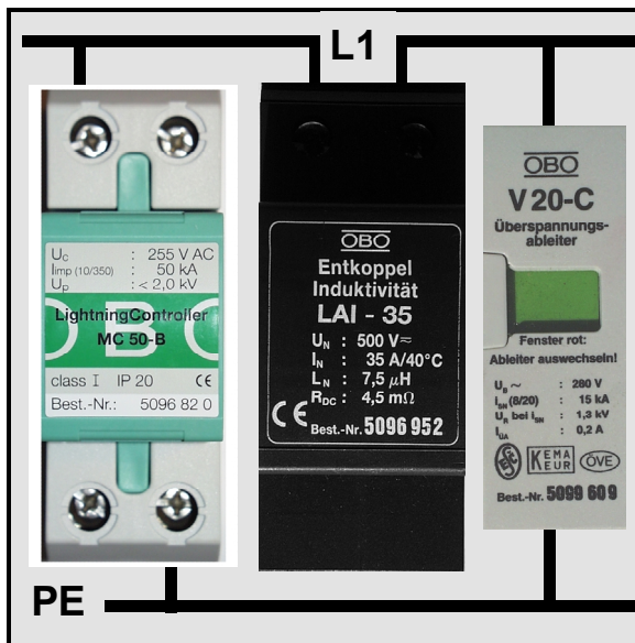
Bild 15 Blitzstromableiter MC 50-B, Entkopplungsspule und Überspannungsableiter V20C zwischen L1 und PE eines Drehstromnetzes geschaltet.
