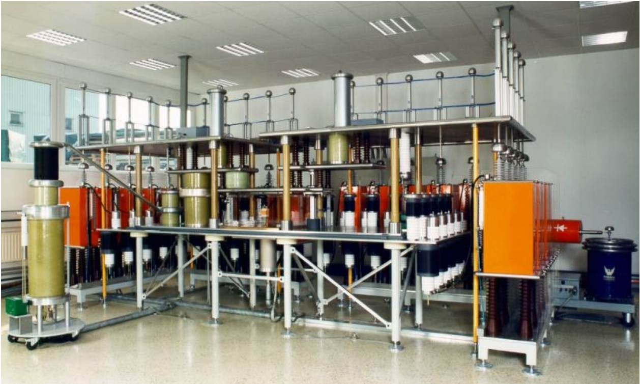
Bild 27 Blitzstromsimulator im BET. 200 kA 10/350 \mu s und andere Impulse. 50 \mu F und 100 kV Ladespannung.
