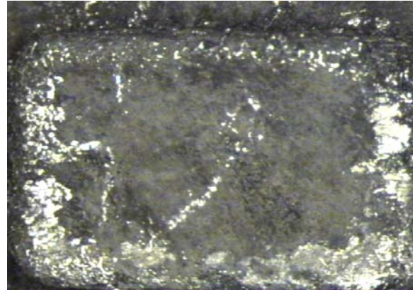
Fester Kontakt, Kontaktfläche = 6x10 mm
