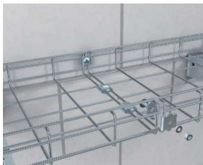
Giunzione lineare di passerella grigliata a C Realizzazione di una giunzione lineare di passerelle grigliate a C con giunto tipo GSV 34.
