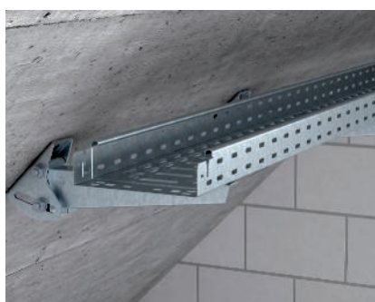
Mensola a parete regolabile Fissaggio della mensola a parete regolabile tipo AWV con bulloni di ancoraggio a soffitti e pareti inclinati o a cupola.
