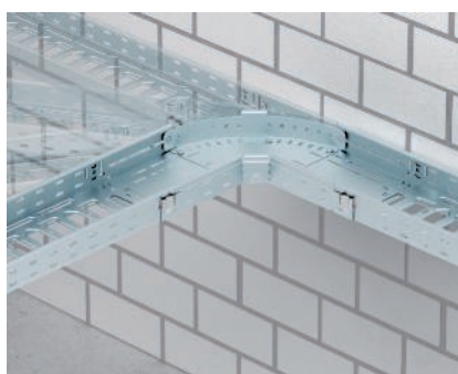
Deviazione di direzione tramite curva Magic variabile Con la curva variabile Magic del tipo RBMV...è possibile inserire deviazioni di direzione continue da 0° a 90° nella guida linee.
