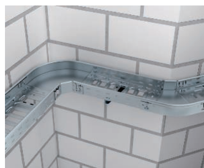
Montaggio della curva Magic Installazione di curve in maniera semplice. Il lato della passerella con la molla si innesta dall'alto nella curva.
