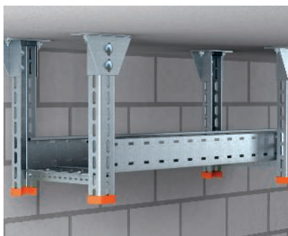
Esempio di montaggio Montaggio di profilato di sospensione su due lati composto da profili a U con traversa. Fissaggio di una passerella portacavi tipo WKSG 110 con viti a testa tonda al profilo trasversale.
