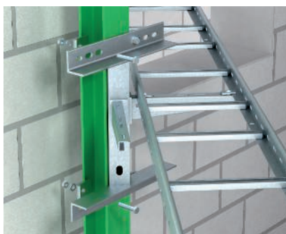
Piastra 45°, fissaggio su acciaio Montaggio della piastra 45° tipo KA-E 45 al supporto in acciaio con angolari di fissaggio o staffe di serraggio. Per un sostegno aggiuntivo su angolari e angoli con tracciati complessi.
