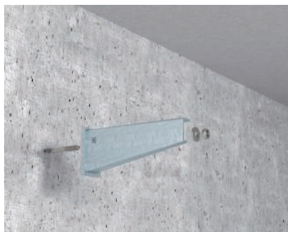
Installazione a parete Fissaggio diretto alla parete di mensole tipo AWV.. a profilato e a parete.
