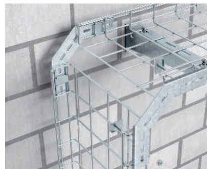
Curva verticale Dettaglio del rinforzo della curva verticale 90° con angolo tipo MW.
