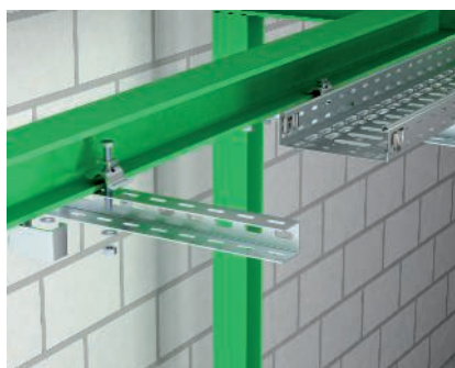
Trave portante collegata alla struttura in acciaio Con l'ausilio di staffe di serraggio leggere tipo TKS-L-25, i profilati a U possono essere utilizzati come cantilever su supporti in acciaio. Per un funzionamento sicuro è necessario utilizzare distanziatori DSK.
