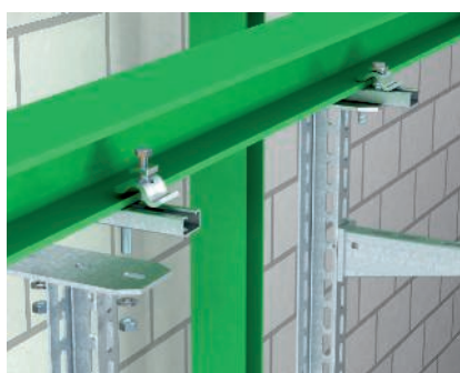
Fissaggio su acciaio con profilato a C, tracciato in direzione longitudinale Montaggio del profilo di sospensione a U, fissato al supporto in acciaio con profilato a C MS 4022 e staffa di serraggio leggera TKH-L-25. Tracciato longitudinale al supporto in acciaio.
