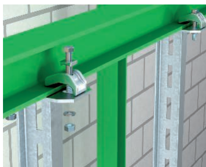
Fissaggio diretto su acciaio Fissaggio diretto su acciaio di un profilato di sospensione a I tramite staffa di serraggio (pesante) tipo TKS-S-30. Tracciato longitudinale al supporto in acciaio.
