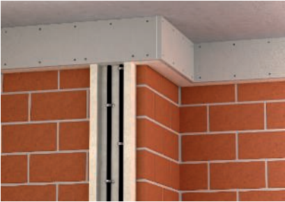
Fissaggio cavi con montaggio canale verticale con fascette/bride.
