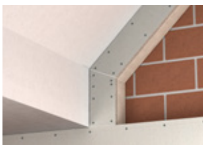
Cheminement flexible des goulottes grâce à des pièces moulées réalisables à souhait
