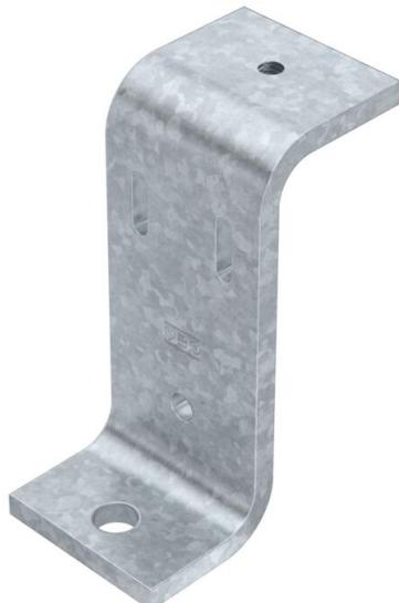
Supporto a Z per elevare il sistema di passerelle portacavi accessibile BKRS a pavimento. Fissaggio della passerella portacavi sul supporto Z con vite a testa piatta FKS 6x 12 mm (n. art. 6049246) in foro filettato M6.
