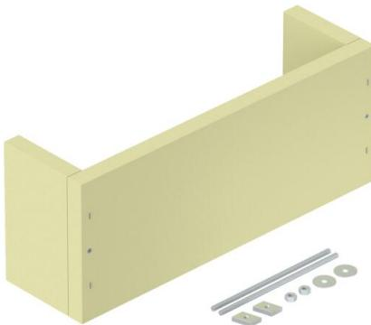
Décharge de traction comme mesure efficace pour pose de câbles verticale selon la norme DIN 4102 partie 12. Homologation pour tous les types de câble et systèmes de pose qui sont posés directement sur les parois massives. Classes de maintien en fonction E30 à E90. Boîtier vide pour remplissage individuel avec la mousse coupe-feu PYROSIT® NG et/ou les blocs de mousse PYROPLUG® Block, y compris kit de montage et plaque d'identification.
