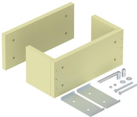
Zugentlastung als wirksame Unterstützungsmaßnahme für senkrechte Kabelverlegung nach DIN 4102 Teil 12. Zugelassen für alle Kabeltypen und Steigeleitern, die als hängende Montage ausgeführt werden. Funktionserhaltklassen E30 bis E90. Leeres Gehäuse zur individuellen Füllung mit Brandschutzschaum PYROSIT® NG und/oder Schaumstoffblöcken PYROPLUG® Block, inkl. Montageset und Kennzeichnungsschild.
