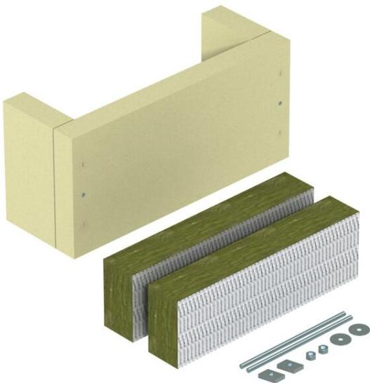
Zugentlastung als wirksame Unterstützungsmaßnahme für senkrechte Kabelverlegung nach DIN 4102 Teil 12, für alle Kabeltypen und alle senkrechten Verlegesysteme zugelassen. Funktionserhaltklassen E30 bis E90. Gehäuse inkl. Mineralfaserplatten, Befestigungsmaterial, Kartusche mit Brandschutzbeschichtung ASX und Kennzeichnungsschild.
