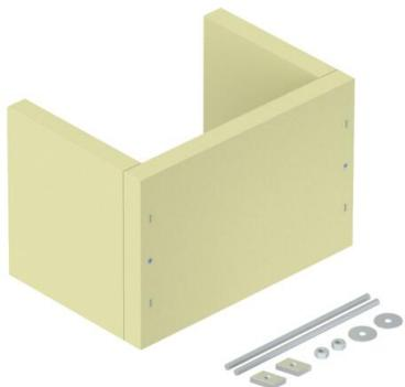
Décharge de traction comme mesure efficace pour pose de câbles verticale selon la norme DIN 4102 partie 12. Homologation pour tous les types de câble et systèmes de pose qui sont posés directement sur les parois massives. Classes de maintien en fonction E30 à E90. Boîtier vide pour remplissage individuel avec la mousse coupe-feu PYROSIT® NG et/ou les blocs de mousse PYROPLUG® Block, y compris kit de montage et plaque d'identification.
