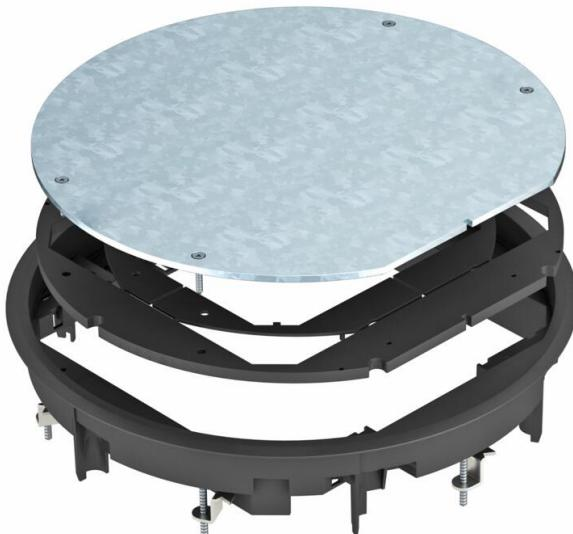
Zugdoseneinsatz zum Blindverschluss einer runden Montageöffnung der Nenngröße R9 in Kanalsystemen sowie in Doppel- und Hohlböden im Innenbereich. Mit Universalbefestigungswinkel. Teppichschutzrahmen aus Polyamid. Bodenbelagstärke max. 12 mm.
