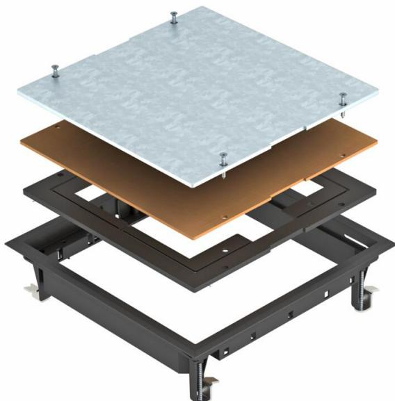
Inserto della scatola di derivazione per la chiusura cieca di un'apertura di montaggio quadrata con dimensione nominale 9 nei sistemi di canali e nei pavimenti doppi o con intercedenzi in ambienti interni. Telaio di protezione moquette in poliammide.
