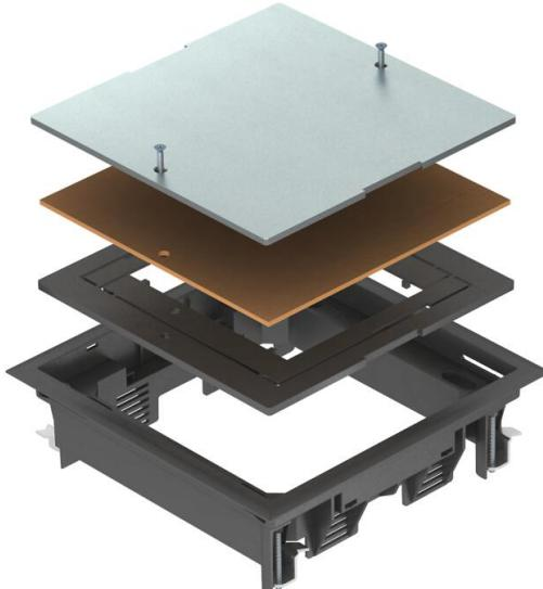
Zugdoseeneinsatz zum Blindverschluss einer quadratischen Montageöffnung der Nenngröße 4, Einsatz in Kanalsystemen und Systemböden im Innenbereich. Bodenbelagauflösung bei Lieferung auf 5 mm eingestellt, bei Bedarf auch einstellbar auf 3, 8 oder 10 mm.
