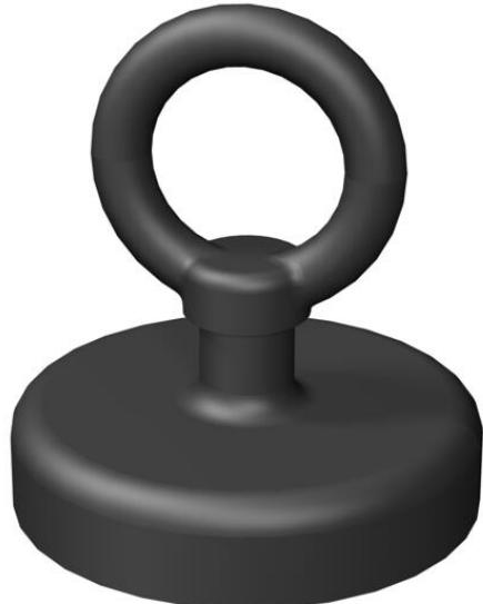
Magnethofer WZ 1028 für das Herausheben von Dosen- und Kanaldeckeln mit überklebten textilen Bodenbelägen mit einer Dicke von 3-10 mm. Haftkraft: 1.300 N
