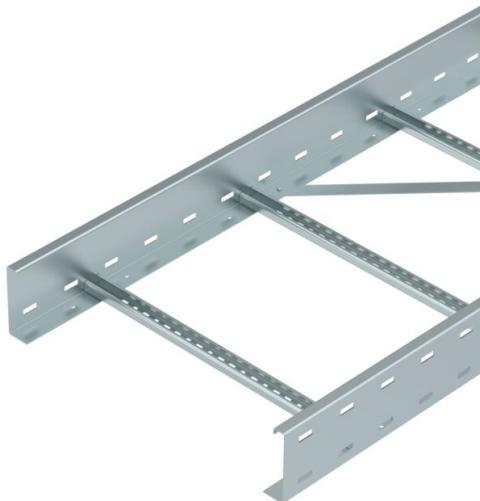
Echelle à câbles longue portée d'une hauteur latérale de 110 mm, avec longeron perforé. Fixation des câbles et de tubes avec bride rapide de type 2056. Les raccords droits WRVL 110 doivent être commandées séparément en quantités requises. Atténuation magnétique du blindage sans couvercle 10 dB, avec couvercle 15 dB.
