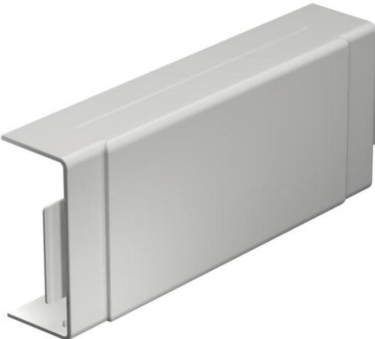
Calotta derivazione a T e a croce per deviazione di direzione dei canali WDK. La calotta è preforata lateralmente per il collegamento di svariate sezioni di canale. Gli accessori sono in genere concepiti come pezzi sagomati del coperchio.
