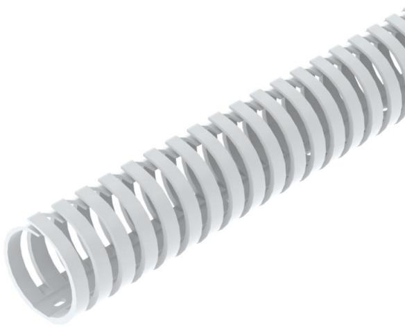
Canale di cablaggio flessibile per una posa orizzontale e verticale nel quadro elettrico. Il canale di tipo KB è dotato di nastro adesivo sul fondo. Montaggio diretto a parete tramite foratura nel fondo. Difficilmente infiammabile e autoestinguente dopo l'allontanamento di una fiamma attiva. Le linguette nella parte inferiore del canale possono essere rotte senza attrezzi. Controllato secondo DIN EN 50085-2-3. Parte inferiore e superiore nel set.
