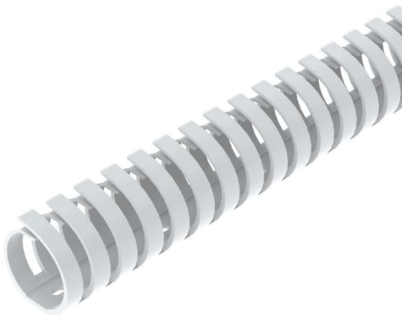
Goulotte de câblage flexible pour la pose horizontale ou verticale dans l'armoire électrique. Le fond de la goulotte de type KB est doté de ruban adhésif. Montage mural direct sur le fond perforé intégré. Difficilement inflammable et auto-extinguible après retrait d'une flamme ardente. Les languettes dans le socle de goulotte peuvent être cassées sans outil. Testé selon DIN EN 50085-2-3. Socle et couvercle dans le set.
