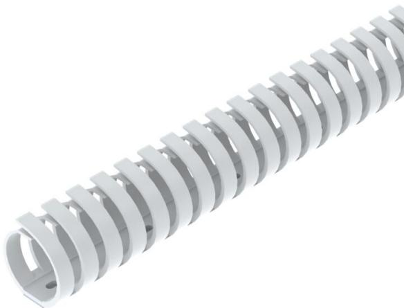
Canale di cablaggio flessibile per una posa orizzontale e verticale nel quadro elettrico. Il canale di tipo KB è dotato di nastro adesivo sul fondo. Montaggio a parete diretto (con nastro biadesivo come ausilio di montaggio) mediante foratura nel fondo. Difficilmente infiammabile e autoestinguente dopo l'allontanamento di una fiamma attiva. Le linguette nella parte inferiore del canale possono essere rotte senza attrezzi. Controllato secondo DIN EN 50085-2-3. Parte inferiore e superiore nel set.
