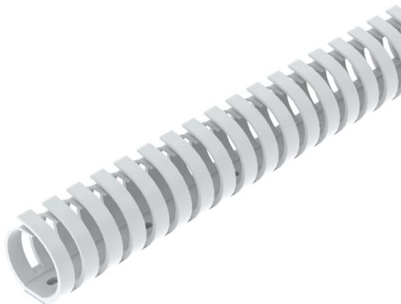
Goulotte de câblage flexible pour la pose horizontale ou verticale dans l'armoire électrique. Le fond de la goulotte de type KB est doté de ruban adhésif. Montage mural direct sur le fond perforé intégré (avec ruban adhésif double face comme aide au montage). Difficilement inflammable et auto-extinguible après retrait d'une flamme ardente. Les languettes dans le socle de goulotte peuvent être cassées sans outil.
