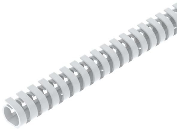
Goulotte de câblage flexible pour la pose horizontale ou verticale dans l'armoire électrique. Le fond de la goulotte de type KB est doté de ruban adhésif. Montage mural direct sur le fond perforé intégré. Difficilement inflammable et auto-extinguible après retrait d'une flamme ardente. Les languettes dans le socle de goulotte peuvent être cassées sans outil. Testé selon DIN EN 50085-2-3. Socle et couvercle dans le set.
