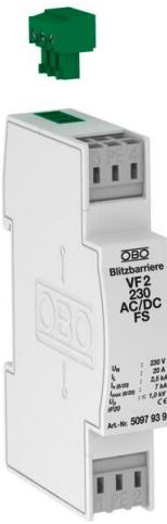
Überspannungsschutz / Netzfeinschutz Typ 3 nach EN 61643-11 mit leckstrom-freier Fernsignalisierung
