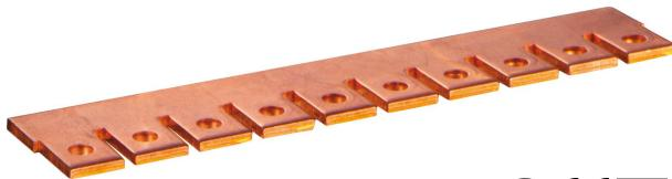
Verbindungsbrücke für 8-mm-Blitzbarrieren • Länge der Brücke anpassbar • Werkstoff Kupfer • Ermöglicht schnellen Potentialausgleich Anwendung: Parallelschalten der MDP-Blitzbarrieren
