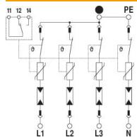
TOV-Spannung [N-PE] - withstand mode - 200 ms | 1200 V
