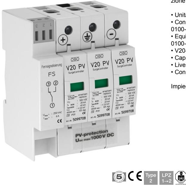
V 20 limitatore di sovratensioni tipo 2 per impianti fotovoltaici dotato di segnalazione con contatto di scambio, privo di potenziale
