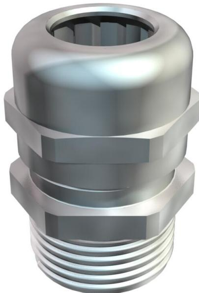
Pressacavo robusto con filettatura di raccordo metrica secondo IEC 423, tipo costruttivo a dado cieco per una forte tenuta. Scarico di trazione e protezione antitorsione. Per scatole con pareti con molto spessore in combinazione con controtdado. Anello di guarnizione in neoprene. Inserto di fissaggio in poliammide. Anello di guarnizione premontato sulla filettatura di raccordo, testato VDE secondo DIN EN 50262, grado di protezione IP 68 a 5 bar per 1 h
