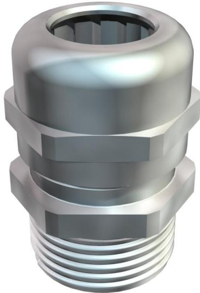
Robuste Kabelverschraubung mit metrischem Anschlussgewinde nach IEC 423 in Hutmutterbauart für hohe Dichtigkeitsansprüche. Zugentlastung, Verdrehschutz und Dichtigkeit über den gesamten Spannbereich. Für dickere Gehäusewandstärken in Verbindung mit Gegenmutter. Dichtring aus Neopren. Klemmeinsatz aus Polyamid. Mit vormontiertem Dichtring am Anschlussgewinde, VDE-geprüft nach DIN EN 50262, Schutzart IP68 bei 5 bar/1 h. Mit langem Anschlussgewinde. \* Preise laut DEL-Notierung.
