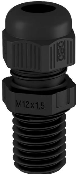
Presse-étoupe avec raccord fileté métrique de type écrou borgne, pour boîtes de dérivation, boîte, coffrets de distribution dans le domaine privé et industriel. Avec décharge de traction et lèvre d'étanchéité intégrée, testé selon la norme DIN EN 62444. Niveau de protection IP68. Utilisation possible de -20 °C à +65 °C
