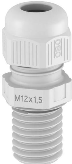
Presse-étoupe avec raccord fileté métrique de type écrou borgne, pour boîtes de dérivation, boîte, coffrets de distribution dans le domaine privé et industriel. Avec décharge de traction et lèvre d'étanchéité intégrée, testé selon la norme DIN EN 62444. Niveau de protection IP68. Utilisation possible de -20 °C à +65 °C
