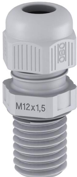
Pressacavo con filettatura metrica, adatto per scatole di derivazione, per applicazioni residenziali ed industriali. Con scarico della trazione e guarnizione di tenuta integrata, testato secondo norma CEI EN 62444. Grado di protezione IP68. Range temperatura -20°C a +65°C.
