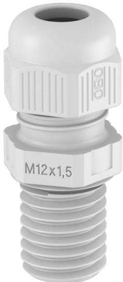
Kabelverschraubung mit metrischem Anschlussgewinde in Hutmutterbauart, für Kabelabzweigkästen, Gehäuse, Verteilerschränke im privaten und industriellen Bereich. Mit Zugentlastung und integrierter Dichtlippe, geprüft nach DIN EN 62444. Schutzklasse IP68. Einsetzbar von -20°C bis +65°C.
