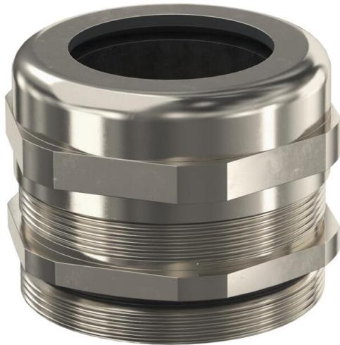
Robuste Kabelverschraubung mit metrischem Anschlussgewinde nach IEC 423 in Hutmutterbauart für hohe Dichtigkeitsansprüche. Zugentlastung, Verdrehschutz und Dichtigkeit über den gesamten Spannbereich. Dichtring aus Neopren. Klemmeinsatz aus Polyamid. Mit vormontiertem Dichtring am Anschlussgewinde, VDE-geprüft nach DIN EN 50262, Schutzart IP68 bei 5 bar/1h, Temperaturereinsatzbereich -20 bis +100°C.
