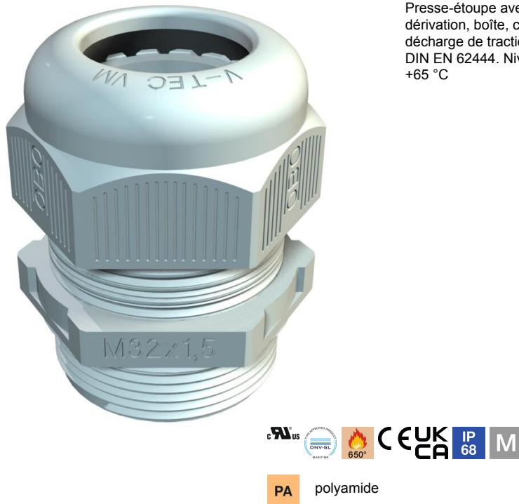
Presse-étoupe avec raccord fileté métrique de type écrou borgne, pour boîtes de dérivation, boîte, coffret de distribution dans le domaine privé et industriel. Avec décharge de traction et lèvre d'étanchéité intégrée, testé selon la norme DIN EN 62444. Niveau de protection IP68. Utilisation possible de -20 °C à +65 °C
