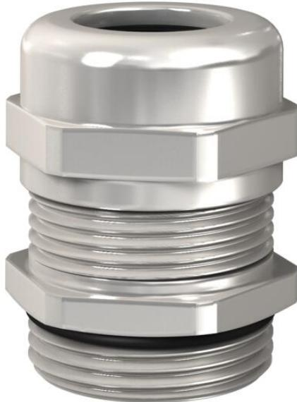
Robuste EMV Kabelverschraubung mit metrischem Anschlussgewinde nach IEC 423 in Hutmutterbauart für hohe Dichtigkeitsansprüche. Zugentlastung, Verdrehschutz und Dichtigkeit über den gesamten Spannbereich. Dichtring aus Neopren. Klemmeinsatz aus Polyamid. Mit vormontiertem O-Dichtring am Anschlussgewinde, VDE-geprüft nach DIN EN 50262, Schutzart IP68 bei 5 bar/1 h. \* Preise laut DEL-Notierung.
