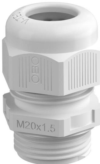
Pressacavo con filettatura metrica, adatto per scatole di derivazione, per applicazioni residenziali ed industriali. Con scarico della trazione e guarnizione di tenuta integrata, testato secondo norma CEI EN 62444. Grado di protezione IP68. Range temperatura -20°C a +65°C.
