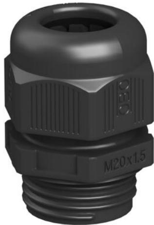
Presse-étoupe avec raccord fileté métrique de type écrou borgne, pour boîtes de dérivation, boîte, coffret de distribution dans le domaine privé et industriel. Avec décharge de traction et lèvre d'étanchéité intégrée, testé selon la norme DIN EN 62444. Niveau de protection IP68. Utilisation possible de -20 °C à +65 °C
