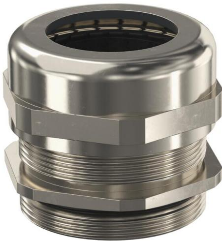
Presse-étoupe robuste de type écrou borgne avec filetage métrique selon la norme CEI 423, pour des exigences d'étanchéité élevées. Décharge de traction, protection antitorsion et étanchéité pour l'ensemble de la plage de serrage. Bague d'étanchéité en néoprène. Garniture de serrage en polyamide. Avec bague d'étanchéité prémontée sur le raccord fileté, testé VDE selon la norme DIN EN 50262, indice de protection IP68 à 5 bar/1 h, plage de température de -20 à +100 °C.
