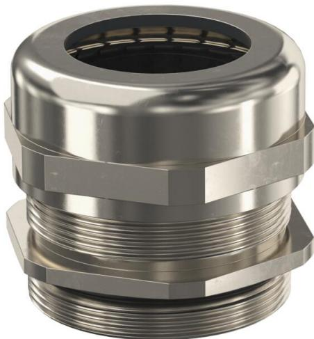
Robuste Kabelverschraubung mit metrischem Anschlussgewinde nach IEC 423 in Hutmutterbauart für hohe Dichtigkeitsansprüche. Zugentlastung, Verdrehschutz und Dichtigkeit über den gesamten Spannbereich. Dichtring aus Neopren. Klemmeinsatz aus Polyamid. Mit vormontiertem Dichtring am Anschlussgewinde, VDE-geprüft nach DIN EN 50262, Schutzart IP68 bei 5 bar/1h, Temperaturereinsatzbereich -20 bis +100°C.
