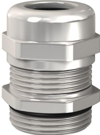
Robuste EMV Kabelverschraubung mit metrischem Anschlussgewinde nach IEC 423 in Hutmutterbauart für hohe Dichtigkeitsansprüche. Die Kontaktierung zwischen Verschraubung und Schirmgeflecht erfolgt über eine Kontaktfeder. Zugentlastung, Verdrehschutz und Dichtigkeit über den gesamten Spannbereich. Dichtring aus Neopren. Klemmeinsatz aus Polyamid. Mit vormontiertem O-Dichtring am Anschlussgewinde, Schutzart IP68 bei 5 bar/1 h.
