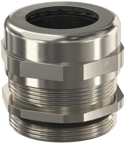
Pressacavo con filettatura di raccordo metrica secondo IEC 423, tipo costruttivo a dado cieco per una forte tenuta. Scarico di trazione, protezione antitorsione e tenuta sull'intero campo di serraggio. Anello di guarnizione in neoprene. Inserto di fissaggio in poliammide. Con anello di tenuta premontato sulla filettatura di raccordo, testato VDE secondo DIN EN 50262, tipo di protezione IP68 a 5 bar/1h, range di temperatura di lavoro da -20 a +100°C.
