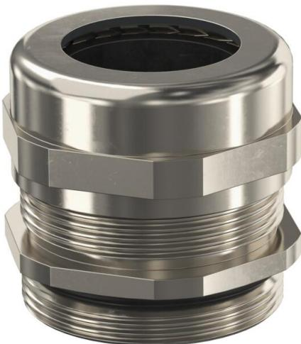
Robuste Kabelverschraubung mit metrischem Anschlussgewinde nach IEC 423 in Hutmutterbauart für hohe Dichtigkeitsansprüche. Zugentlastung, Verdrehschutz und Dichtigkeit über den gesamten Spannbereich. Dichtring aus Neopren. Klemmeinsatz aus Polyamid. Mit vormontiertem Dichtring am Anschlussgewinde, VDE-geprüft nach DIN EN 50262, Schutzart IP68 bei 5 bar/1h, Temperaturereinsatzbereich -20 bis +100°C.
