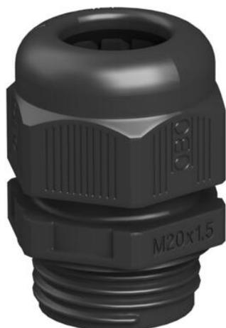
Presse-étoupe avec raccord fileté métrique de type écrou borgne, pour boîtes de dérivation, boîte, coffret de distribution dans le domaine privé et industriel. Avec décharge de traction et lèvre d'étanchéité intégrée, testé selon la norme DIN EN 62444. Niveau de protection IP68. Utilisation possible de -20 °C à +65 °C
